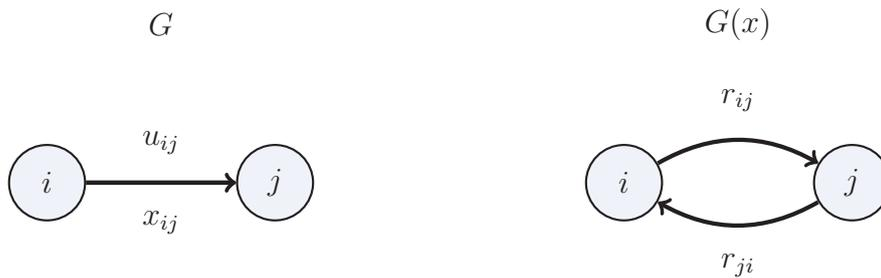
Die Restkapazitäten beschreiben mögliche Änderungen an der Flussfunktion. Eine Erhöhung geschieht in Richtung der Kante  $(i, j)$  ( $\max r_{ij} = u_{ij} - x_{ij}$ ) und eine Verminderung in die Gegenrichtung ( $\max r_{ji} = x_{ij}$ ).
